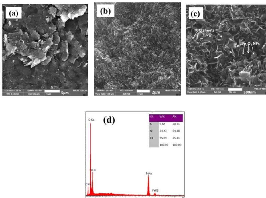
**Fig. 3.** FE-SEM images of (a) GO, and (b,c)  $\text{Fe}_3\text{O}_4/\text{GO}$  composite and (d) its EDS data
